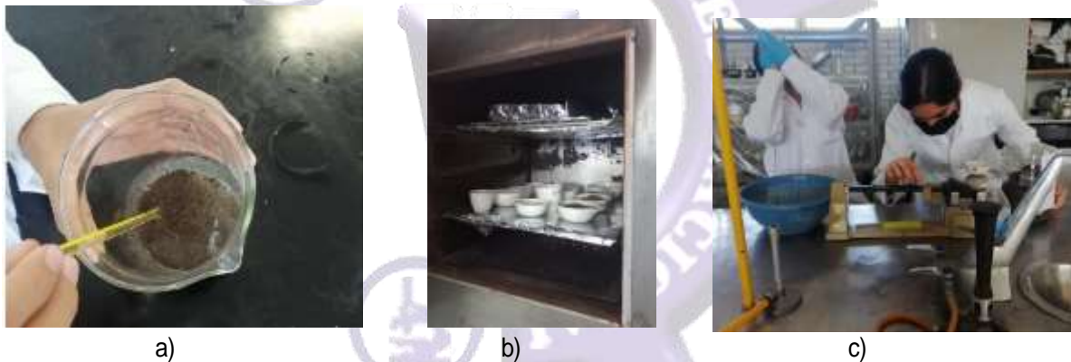
Figura 3. Imágenes de la caracterización del sustrato. a) dilución del sustrato con agua destilada para usar un equipo multiparametrico que mide conductividad, ph y temperatura, b) horno de secado y c) medición de la humedad del sustrato, con muestras que se acababan de sacar del horno para encontrar un peso constante.
